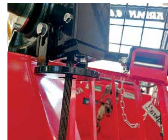
Bild 4: Auch Endschalter im Bereich der Seileinlaufrolle führen zu einer Reduktion der Belastungen an der Seilendverbindung und erhöhen deren Lebensdauer.
