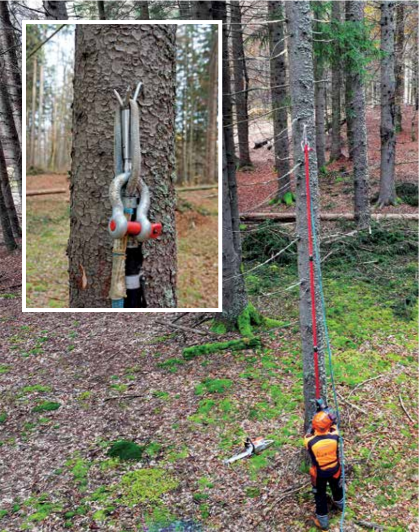
Das Hilfsseil lässt sich mithilfe einer Teleskopstange vom Boden aus in einer Höhe von über 8 Metern anschlagen. Fotos: FAST Ossiach des BFW
