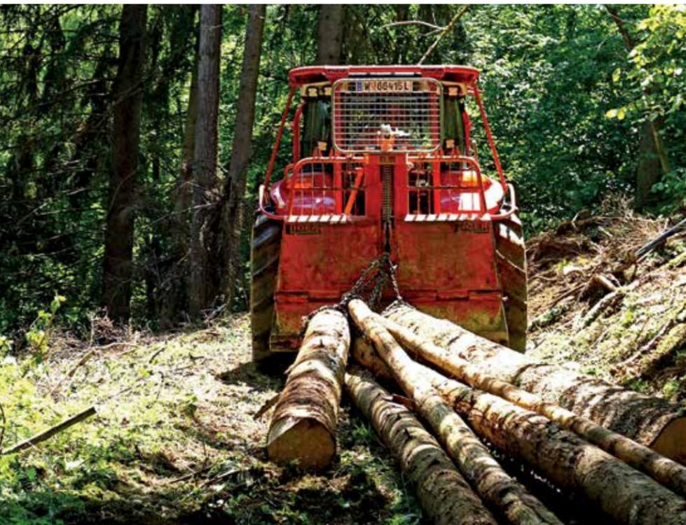
Die Seilwinde im Einsatz im bäuerlichen Kleinwald – trotz technischer Neuerungen bleibt sie ein zentrales Arbeitsmittel. Foto: FAST Ossiach/Thaler
