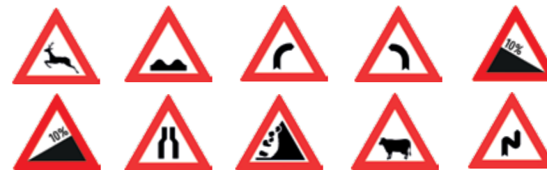
Gefahrenzeichen sind vom Strassenerhalter im Rahmen der Instandhaltungspflicht des Weges anzubringen, wie z.B. die hier abgebildeten.
