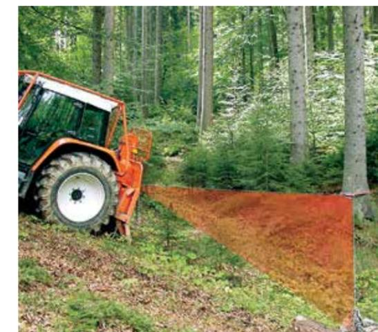
Umlenkrollen müssen immer auf die maximale Zugkraft der Seilwinde abgestimmt werden.
