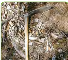
Mit dem langen Hauenblatt können auch Bäumchen mit langer Wurzel gepflanzt werden.
